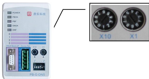
图 2-7 PROFIBUS 从站地址设置开关 SA，地址设为 19
