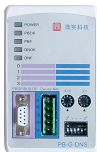
图 2-8 DeviceNet 从站地址设置开关 SA，地址设为 15H=21
